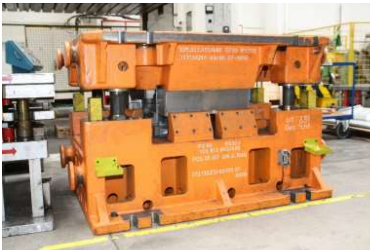
Tandem die Škoda SK481 Superb 1732x1072x920 mm, 4,4 t
