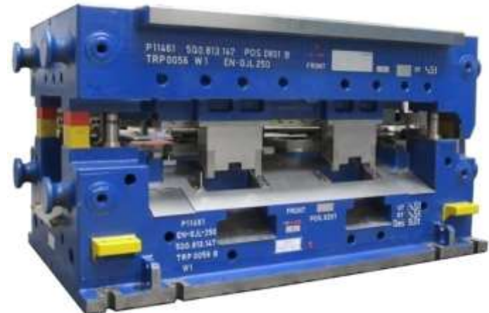
Blank die VW MQB QTR Verst Fersenteil 2510x1340x1150mm, 9 t
