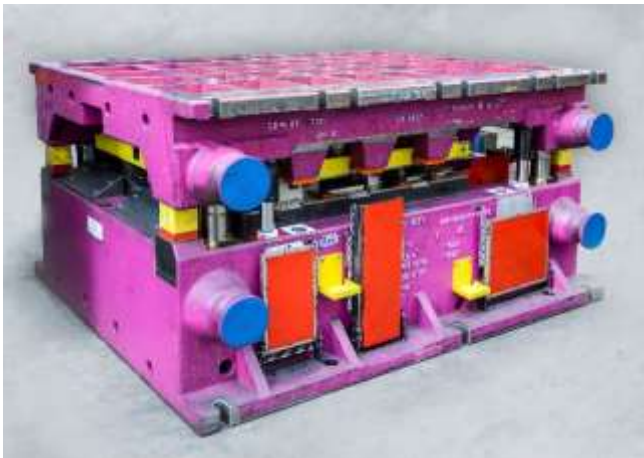
Blank die Škoda YETI SK326 Träger Stossf 2320x2068x1130 mm, 16,6 t
