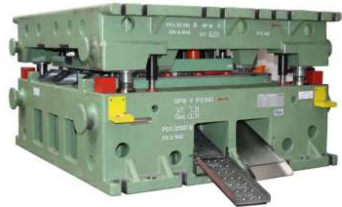
Blank die Škoda SK37X TA 2180x2210x1200mm, 14,9 t
