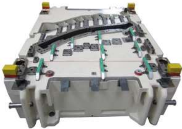
Blank die Škoda A-Entry B-Säule 2575x1180x1010mm, 13 t
